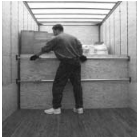
شکل ۳-۹۲- ثابت نگه داشتن بار توسط میله‌های نگهدارنده [۵]
