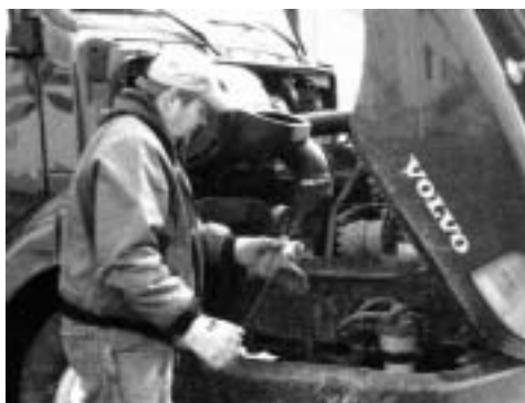
شکل ۳-۴- نحوه کنترل روزانه روغن [۵]
