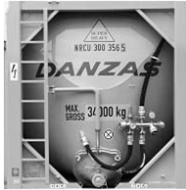
شکل ۳-۱۶- مدخل خروجی تانکر حامل مواد خطرناک [۹]
