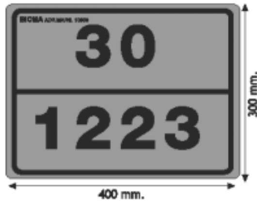
شکل ۲۷-۳- تابلوی ثابت مخصوص نمایش شماره شناسایی و شماره بین‌المللی
